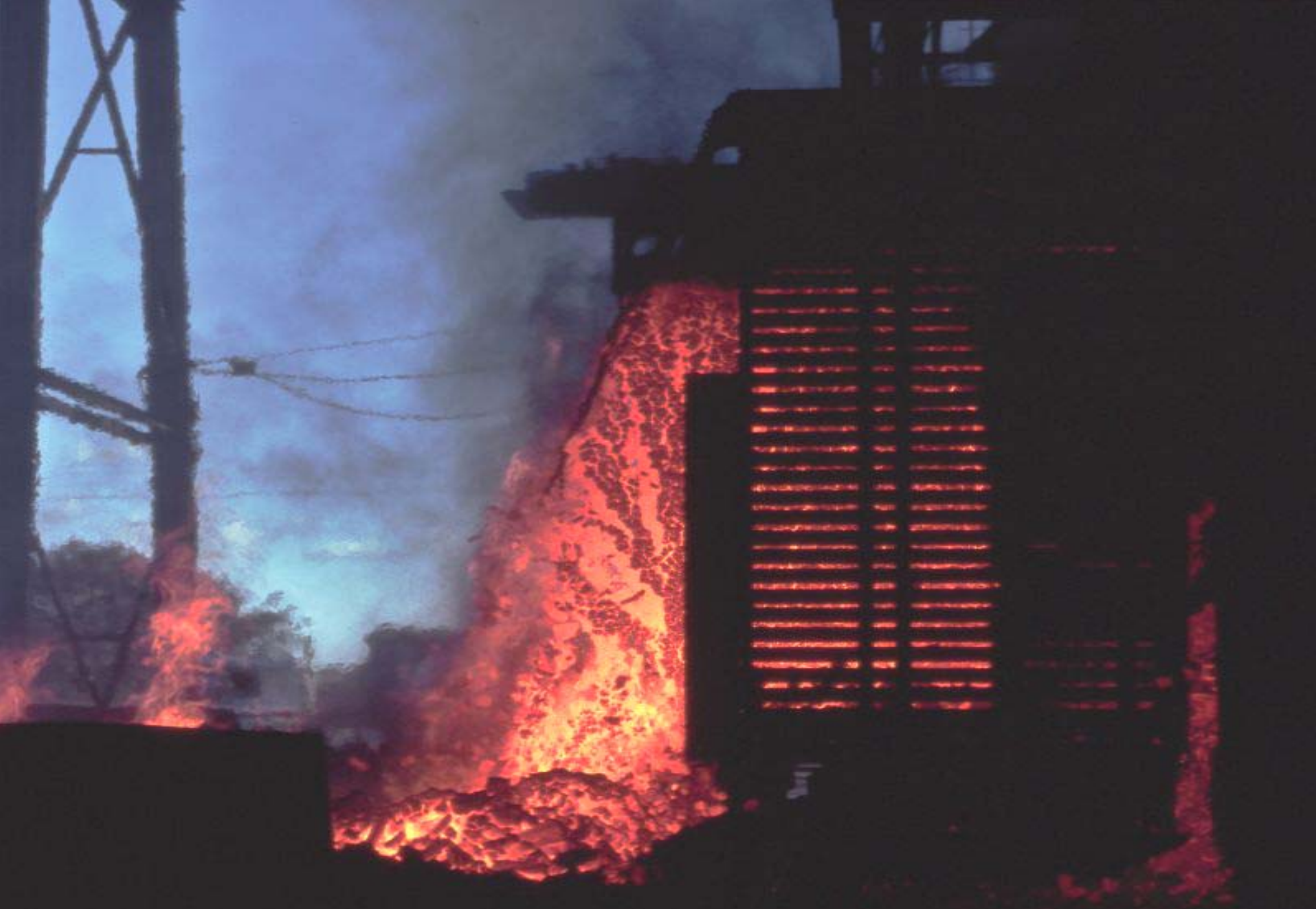
užareni koks istiskuju iz komore i potom polijevaju vodom
